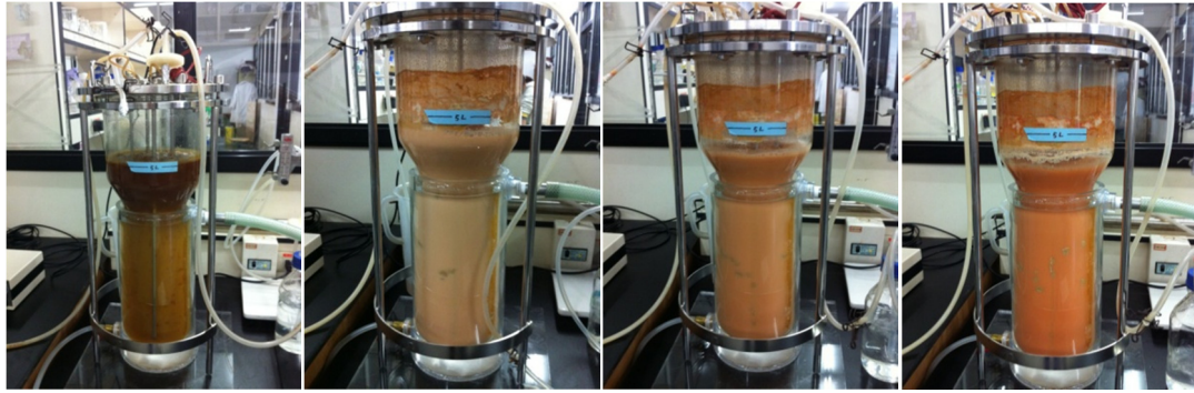
圖 4-14 5 L 氣舉式發酵槽， R. glutinis 在通氣量 1.5 vvm 下 240 hr 之變化情形
