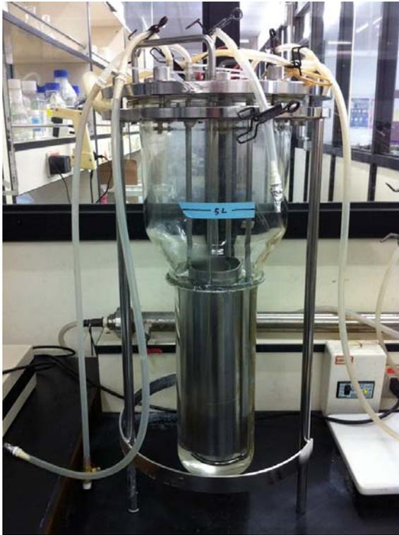
圖 3-3 氣舉式發酵槽裝置圖
