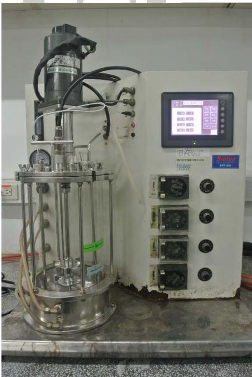
圖 3-4 攪拌式發酵槽裝置圖
