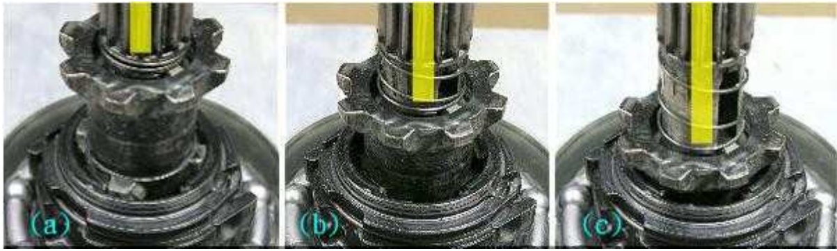
圖 44 變速控制裝置影響換檔滑套作動圖示
