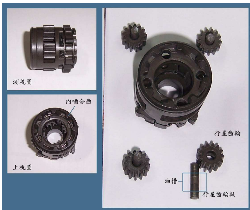
圖 45 零件編號 3-Carrier Unit 組裝好的行星齒輪座及分解圖
