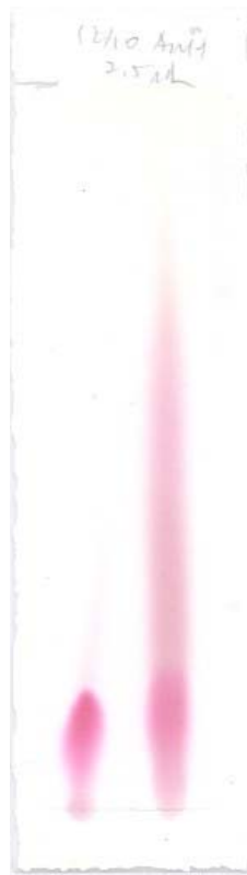
圖 3-9 愛玉子果托花青素纖維素薄層層析圖(展開系統為 MAW, 左側為經 XAD-7 管柱及濾紙純化, 右側只經過 XAD-7 管柱)
