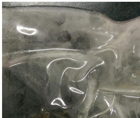
圖4-2 聚乙烯醇縮甲醛薄膜乾燥過程中發生捲曲現象
