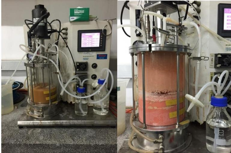
圖 3-4 5 L 攪拌式發酵槽裝置圖
