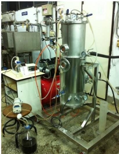
圖 3-5 50 L 氣舉式發酵槽裝置圖
