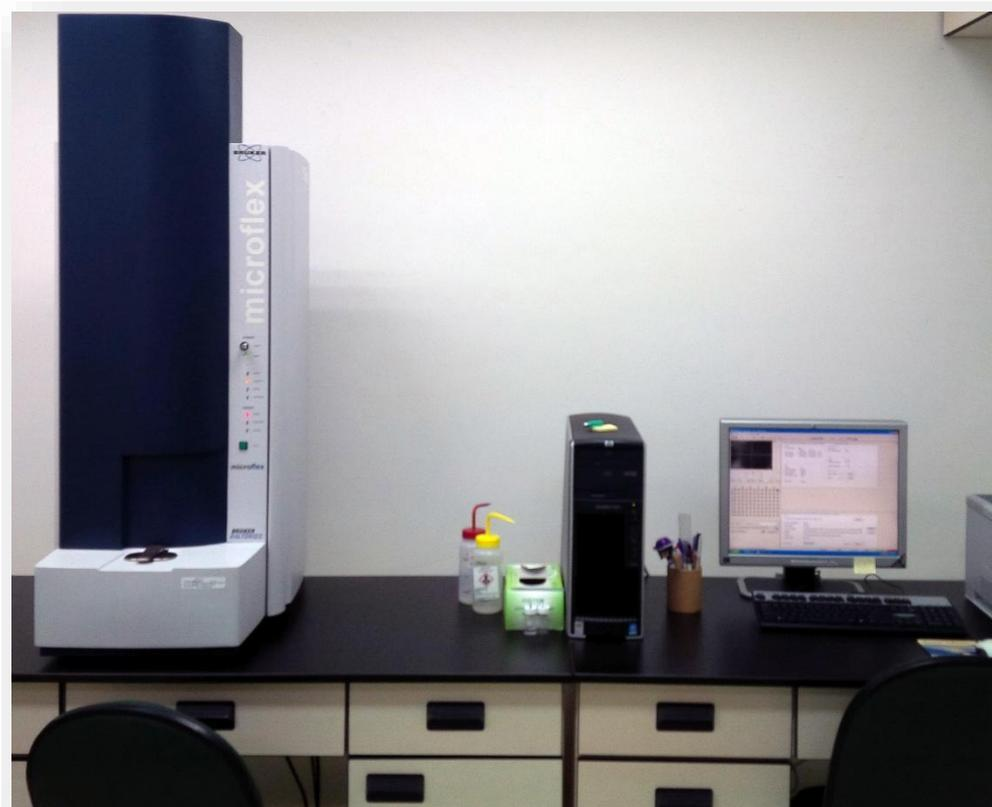
【圖三】基質輔助雷射脫附游離飛行時間質譜儀。
