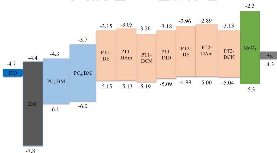
圖 38. 電池各層材料的能階
