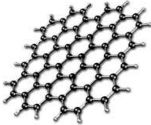
圖 2-5 石墨烯的平面二維結構。
