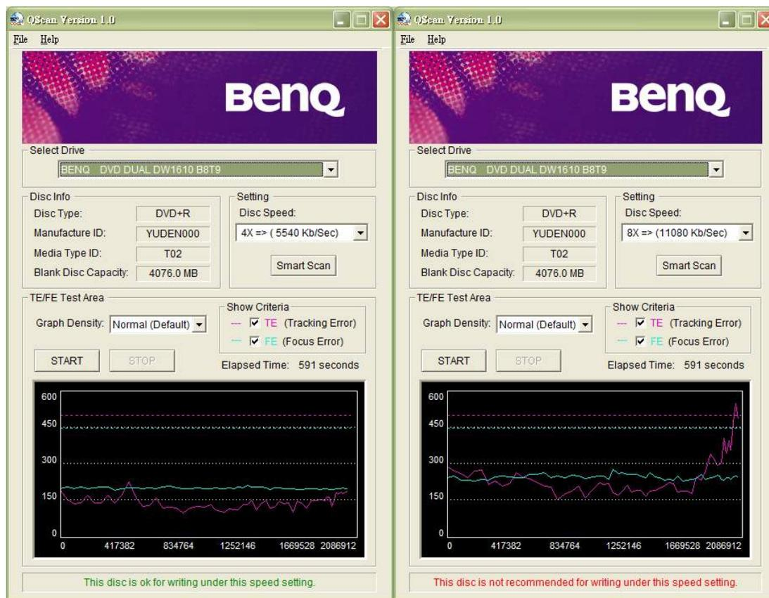
圖2.3 TE/FE測試圖(4X)
