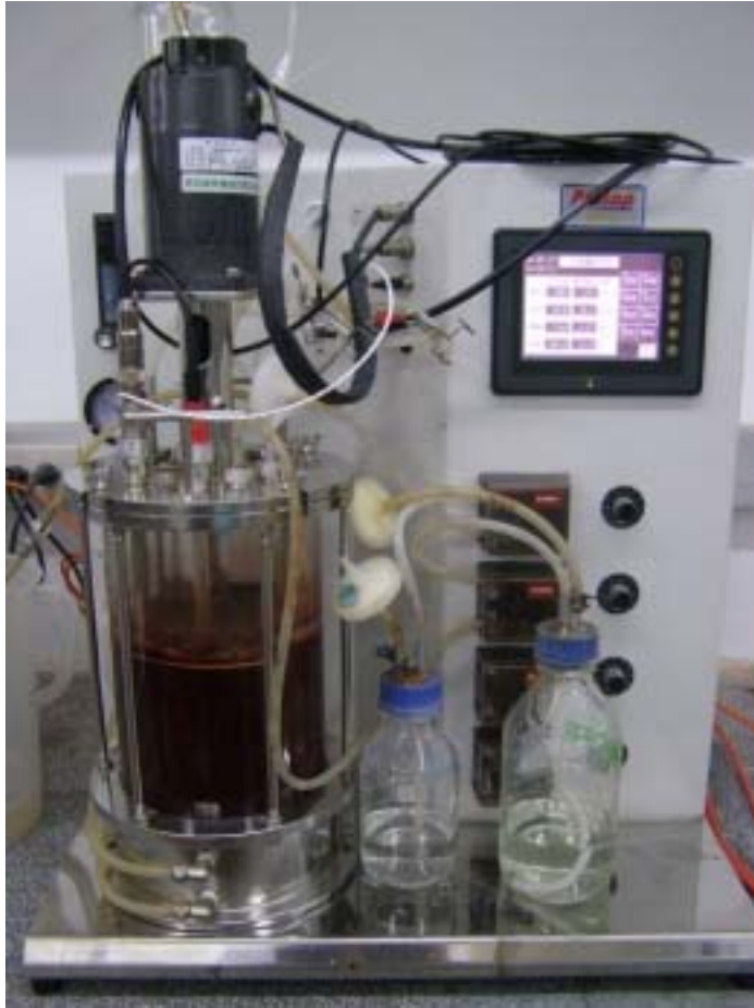
圖 3-6 氣舉式醱酵槽操作照片
