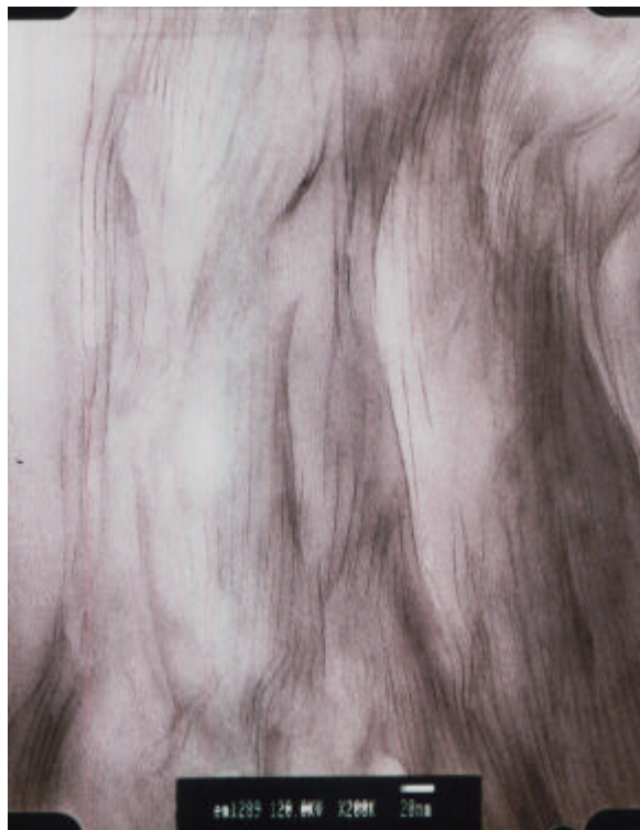
圖 5-20(c)系統二 epoxy/clay 奈米複材(3wt%)的 TEM 影像圖(×200K)
