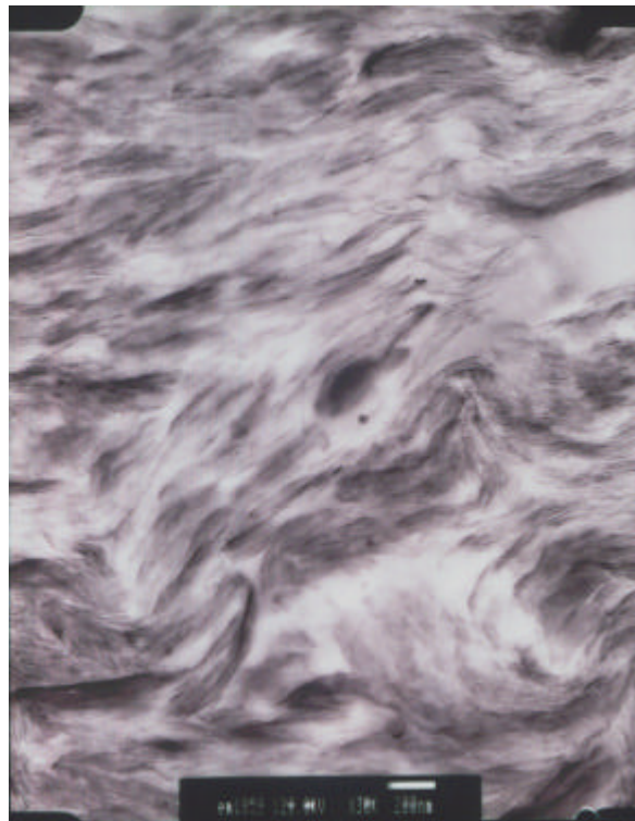
圖 5-7(a)系統一 epoxy/clay 奈米複材(1wt%)的 TEM 影像圖(×30K)
