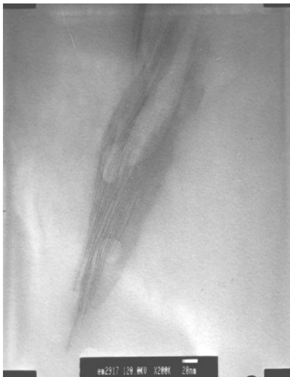
圖 5-30(c)系統三 epoxy/clay 奈米複材(1wt%)的 TEM 影像圖(×200K)
