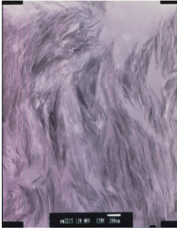
圖 5-21(a)系統二 epoxy/clay 奈米複材(5wt%)的 TEM 影像圖(×30K)
