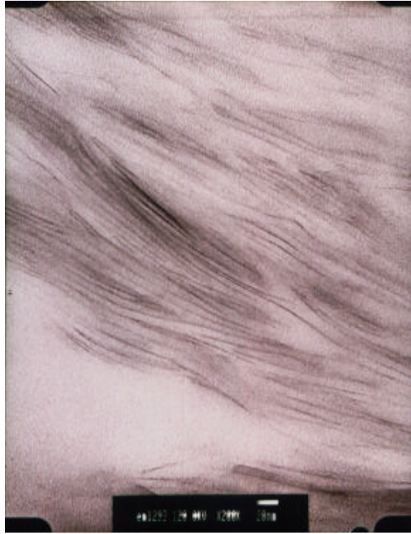
圖 5-8(c)系統一 epoxy/clay 奈米複材(3wt%)的 TEM 影像圖(×200K)
