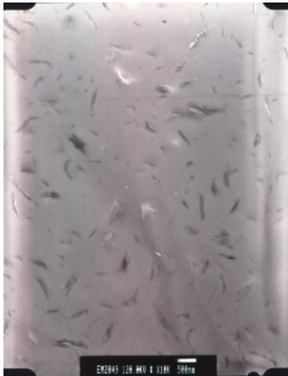
圖 5-31(a)系統三 epoxy/clay 奈米複材(3wt%)的 TEM 影像圖(×10K)
