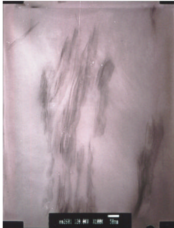
圖 5-32(b)系統三 epoxy/clay 奈米複材(5wt%)的 TEM 影像圖(×100K)
