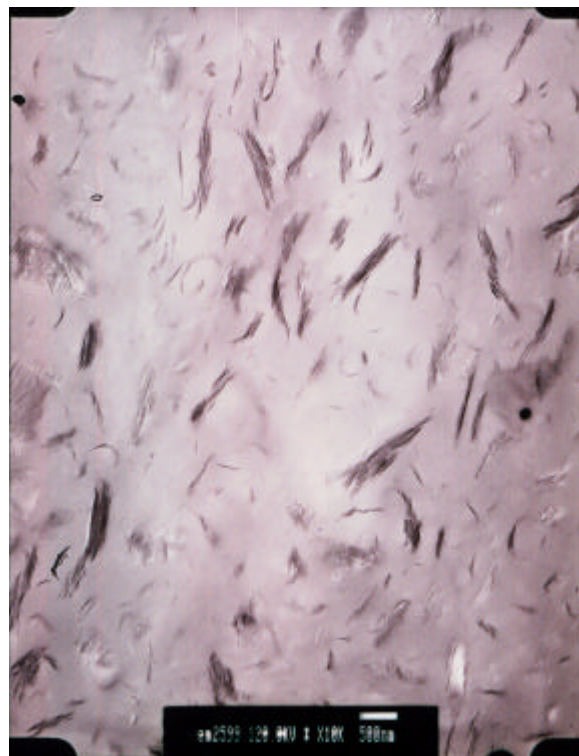
圖 5-32(a)系統三 epoxy/clay 奈米複材(5wt%)的 TEM 影像圖(×10K)
