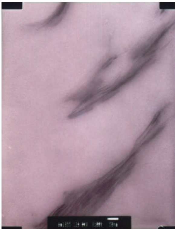
圖 5-31(b)系統三 epoxy/clay 奈米複材(3wt%)的 TEM 影像圖(×100K)
