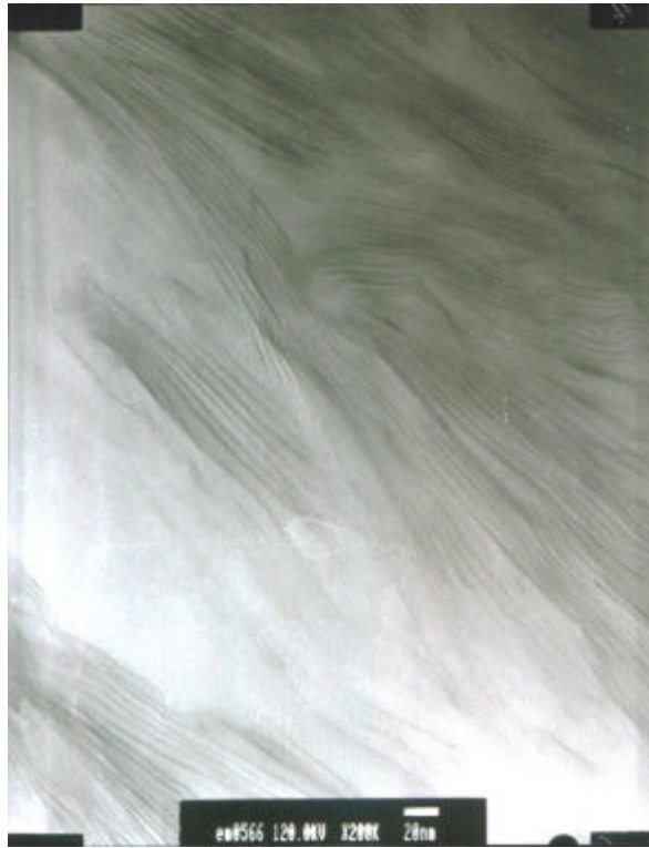
圖 5-21(c)系統二 epoxy/clay 奈米複材(5wt%)的 TEM 影像圖(×200K)
