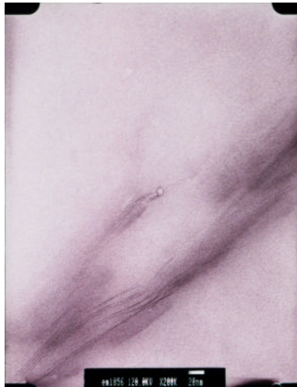
圖 5-31(c)系統三 epoxy/clay 奈米複材(3wt%)的 TEM 影像圖(×200K)
