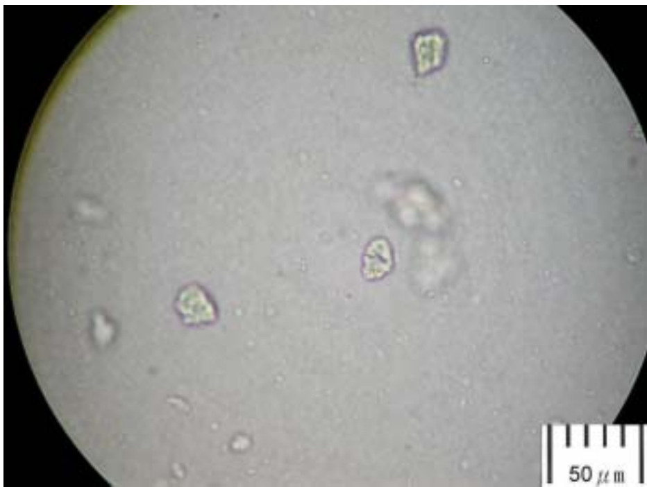
圖 5-9. 熔融法 PB3150/I30P(99/1)之 OM 圖(magnification=800X)
