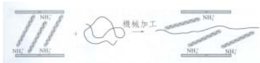
圖 2-5. 熔融層插製備 PLS 奈米複合材料示意圖
