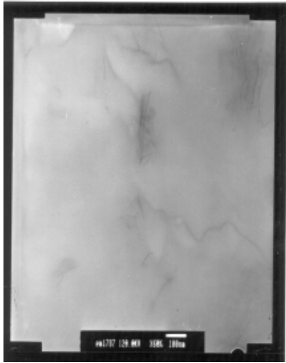
圖 5-14. 熔融法 PB3150/I30P(97/3)之 TEM 圖 (magnification=60kx)
