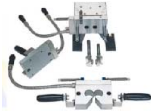
圖 4-3. 塑譜儀轉子零件示意圖
