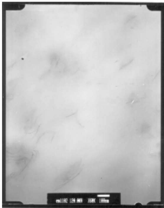
圖 5-19. 溶液法 PB3150/I30P(95/5)之 TEM 圖 (magnification=60kx)
