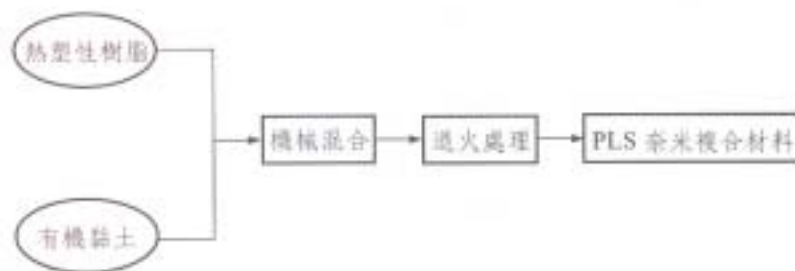
圖 2-12. 高分子熔融插層技術示意圖
