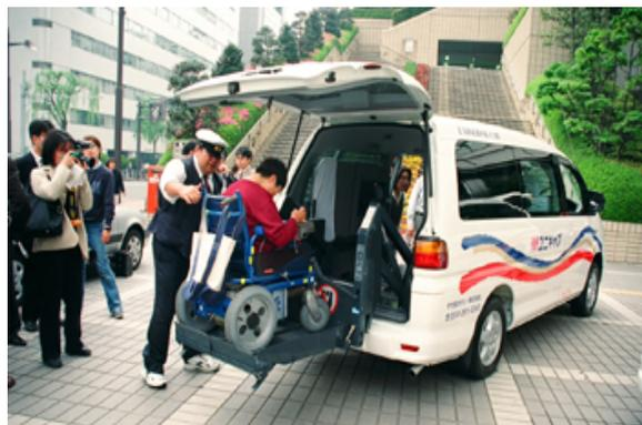
圖 3-3.8 附有升降機的箱型計程車 (資料來源：千代田計程車)
