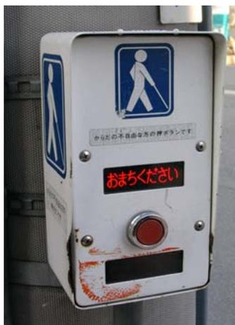
圖 3-3. 54（左圖）輔助視障者的過路機器
