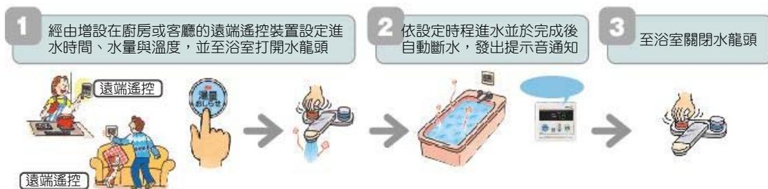
圖 3-3. 16 遠端遙控熱水器的進水流程（資料來源：高木產業）
