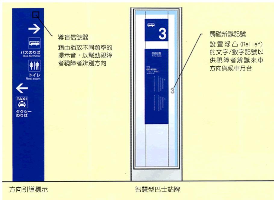
圖 3-1.24 多元感知標示系統，以指示音誘導視障者行進方向，並以點字系統告知巴士行駛方向與路線號碼 (資料來源：靜岡縣政府)
