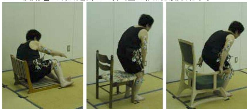
圖 3-1.35 針對座椅開發所進行的高齡者起立動作體能負擔之三次元動作解析計測實驗
