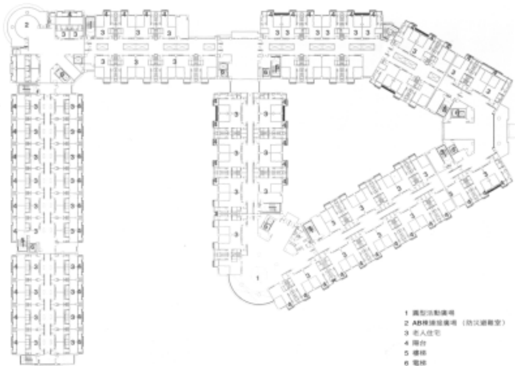
圖 2.3.2：大型機構式高齡者住宅平面組織方式：以長庚養生文化村為例
