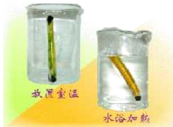
圖六、 $\text{CuCl}_4^{2-}$  在低溫與高溫下的幾何結構
