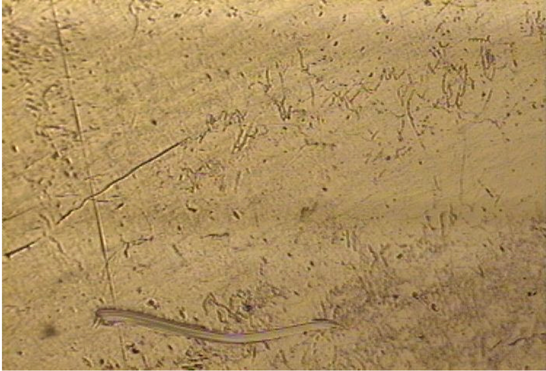
圖 3a.退火處理前，黃金表面並無晶格面。(325X)
