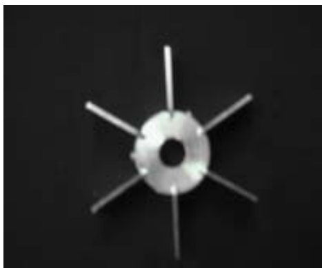
圖七 攪拌式發酵槽之攪拌葉片
