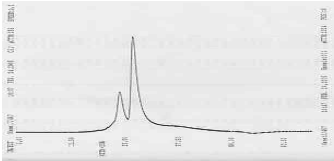
附圖五、攪拌式發酵槽 0.5vvm 通氣量在第三天的茯苓多醣體膠體層 析沖提圖
