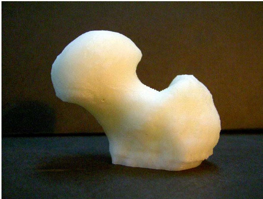
圖 5-25 大腿骨應用 RP 快速原型-視圖二
