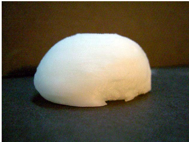
圖 5-18 頭蓋骨應用 RP 快速原型
