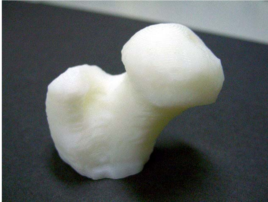
圖 5-24 大腿骨應用 RP 快速原型-視圖一
