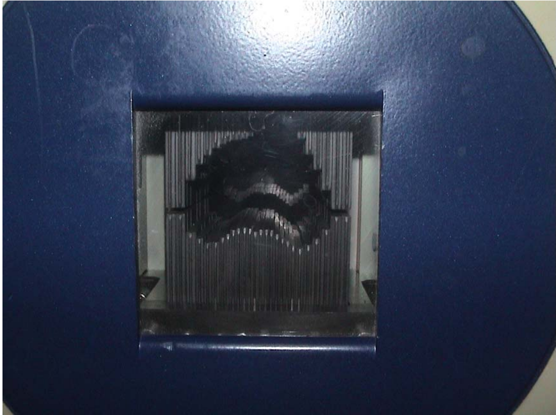
圖 2-14 微多葉準直儀(mMLC)，控制 X 光的輸出範圍
