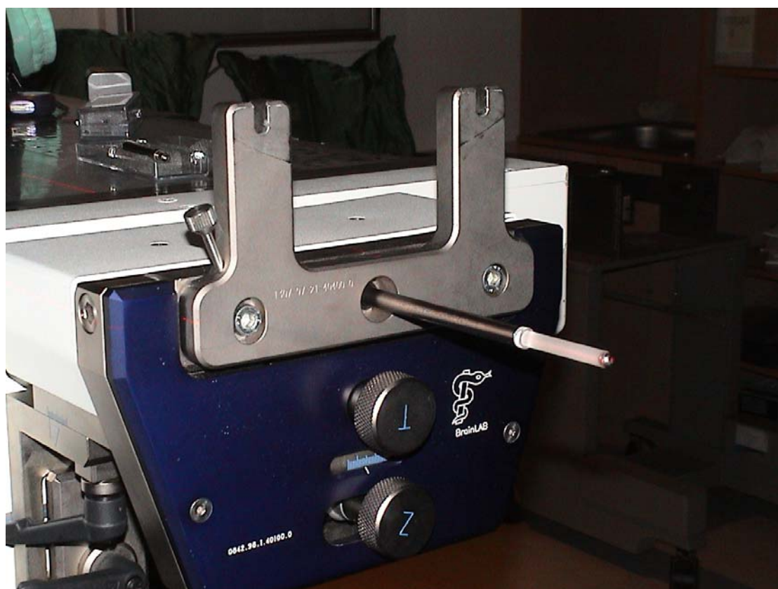
圖 2-13 Winston Lutz test 中，一個 5 mm 的鎢製金屬小球
