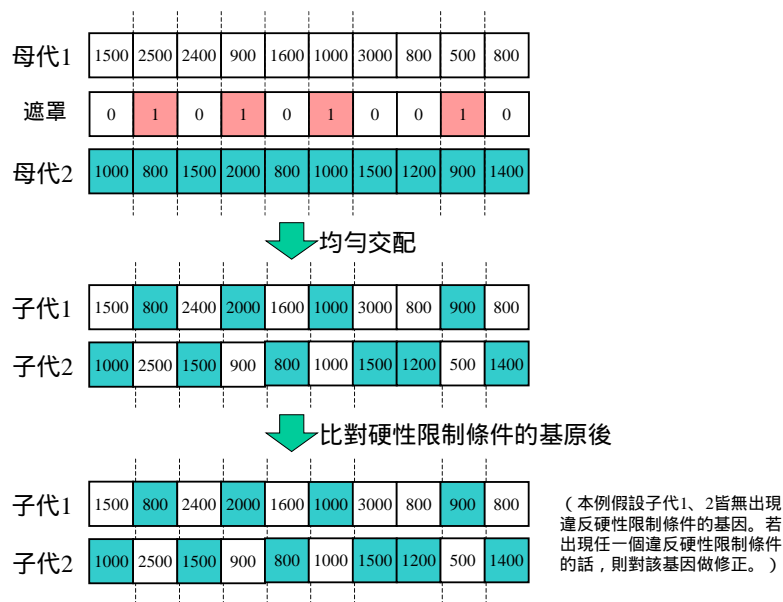
圖 4.4 均勻交配運算子的運算程序
