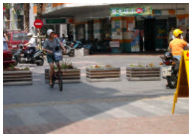
圖 4-15 設施類之封閉時的公設車阻 資料來源：本研究拍攝
