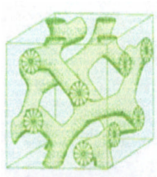
圖 1.1 MCM 中孔型分子篩之結構圖。(a)MCM-41；(b)MCM-48；(c)MCM-50。
