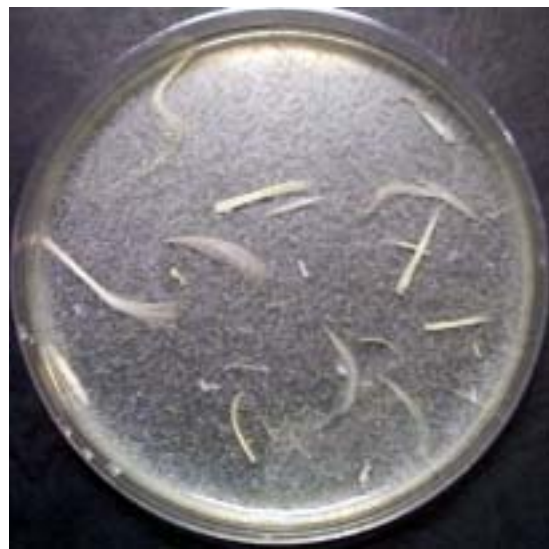
圖二十、1% 完整雞毛經 B. licheniformis THSC-1 分解後之外觀變化
