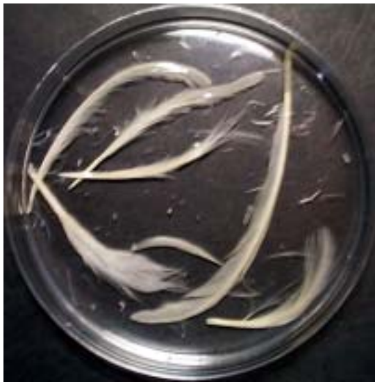
圖二十、1% 完整雞毛經 B. licheniformis THSC-1 分解後之外觀變化
