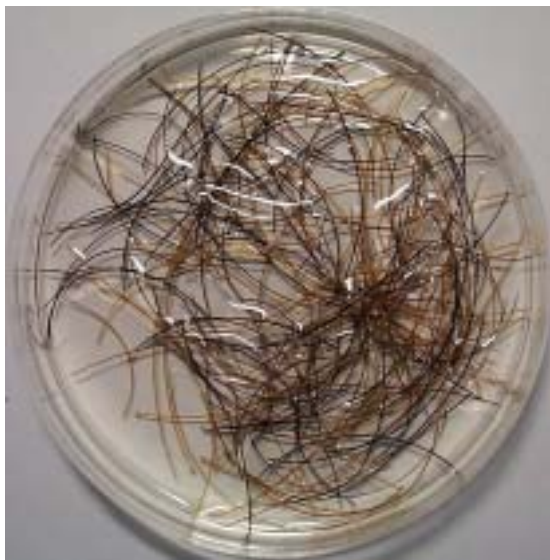
圖二十六、1%完整豬毛經 B. licheniformis THSC-1 分解後之外觀變化
