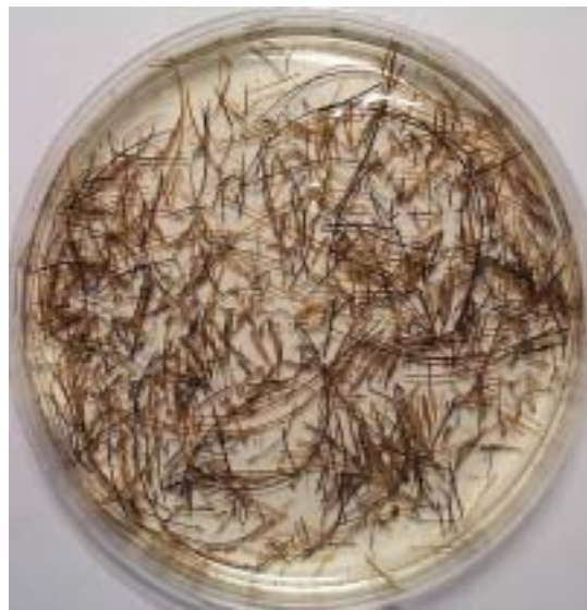
圖二十六、1%完整豬毛經 B. licheniformis THSC-1 分解後之外觀變化
