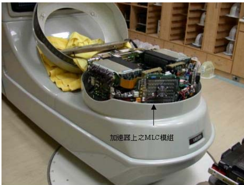
圖 2.2 直線加速器中之 MLC 模組。
