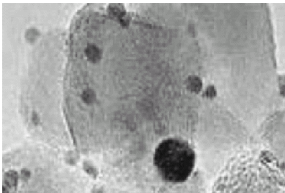
圖 1.6 在二氧化鈦載體上的奈米金粒子[17]
