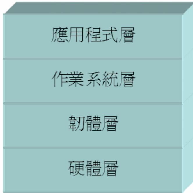
圖 1、複雜型嵌入式系統的系统架構圖
