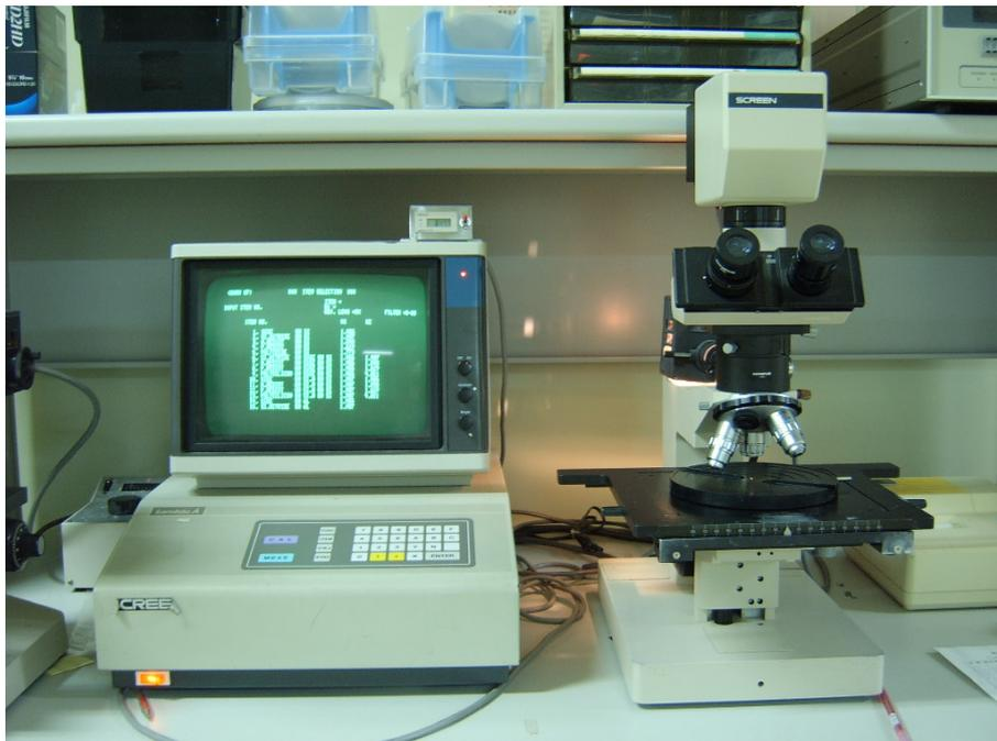
圖 3-9：光學薄膜測厚儀(nanospec)全貌
